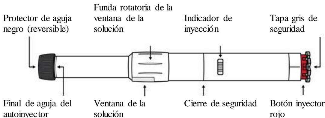
**Funda rotatoria de la ventana de la solución:** El paciente gira la cubierta sobre la ventana de la solución para alinear la lente con la ventana de la solución del Autoinyector.
