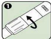
1. Gire la funda que protege la ventana de la solución completamente hacia la dirección que muestran las flechas para alinear la lente con la ventana de la solución del Autoinyector.
