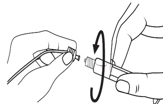
3. Conectar la punta de la jeringa al Sistema de tubos girando a la derecha y siga las instrucciones del fabricante de dispositivo
