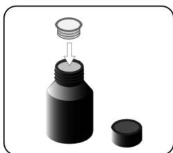
Solo antes del primer uso, empuje el adaptador **hasta que se ajuste completamente** al frasco. No ensamble la jeringa al adaptador hasta que el adaptador esté completamente insertado en el frasco.
