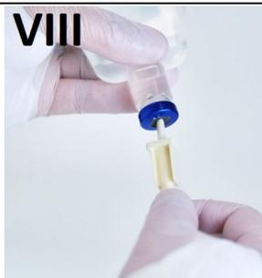
Ahora es preciso eliminar el aire del banco de llaves y de la vía de entrada conectada. Tenga en cuenta que el ácido clorhídrico fluirá a través de la vía y de los puertos laterales y puede gotear. Prepárese para eliminar las gotas de inmediato.
