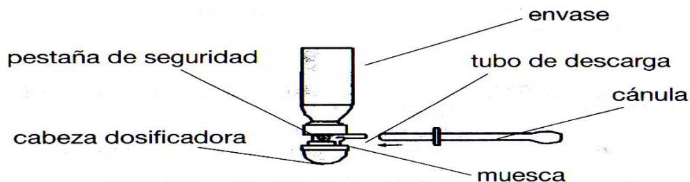
Antes de utilizar por primera vez, desplazar y arrancar, con el envase en **posición vertical**, la pestaña de seguridad de la cabeza dosificadora.
