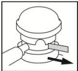
Antes de utilizar, retirar el cierre de seguridad (solapa de plástico) de la cabeza dosificadora.
